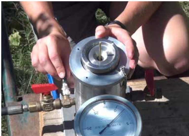
Photo 1: Mesure du potentiel hydrique foliaire de tige à l'aide d'une chambre à pression dite de Scholander: une méthode lourde à mettre en oeuvre
