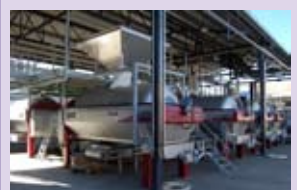
Batterie de pressoirs pneumatiques chez St CLair
