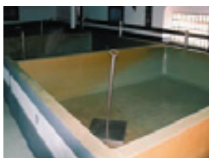
Les cuves de macération (lagar) traditionnellement en granite sont peu à peu remplacées par des lagars en béton recouvert d'époxy
